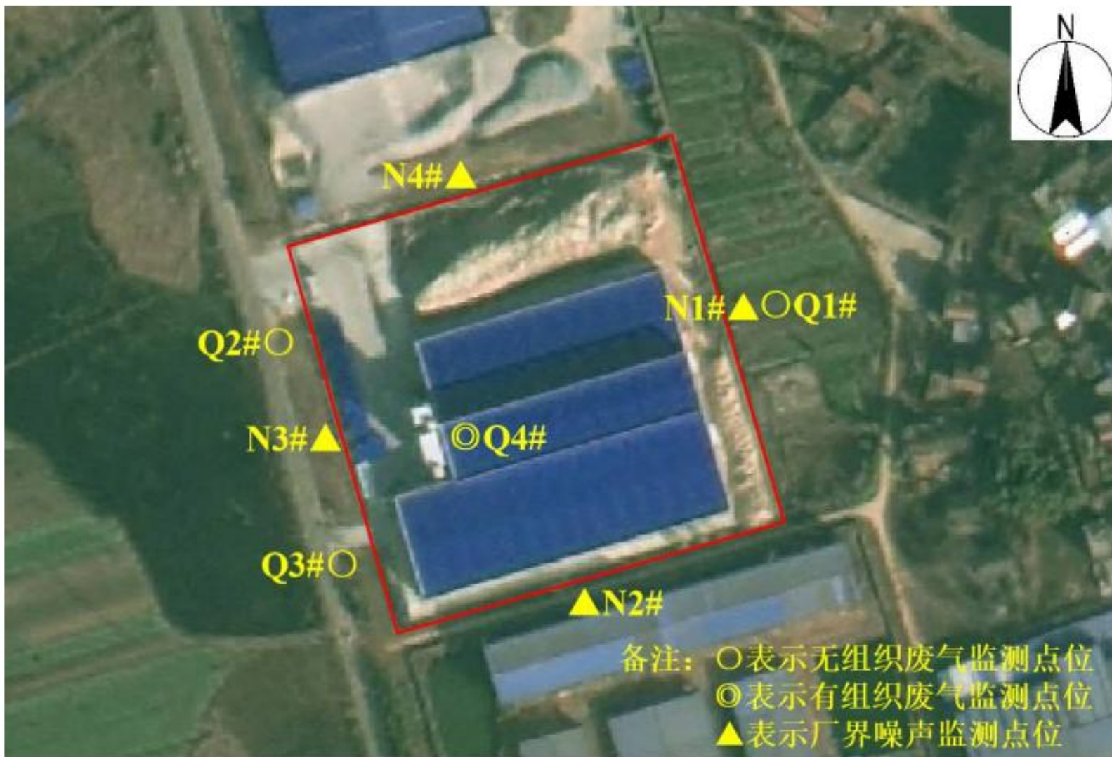
附图3 年产20万吨石膏煅烧线建设项目阶段性验收监测点位图
